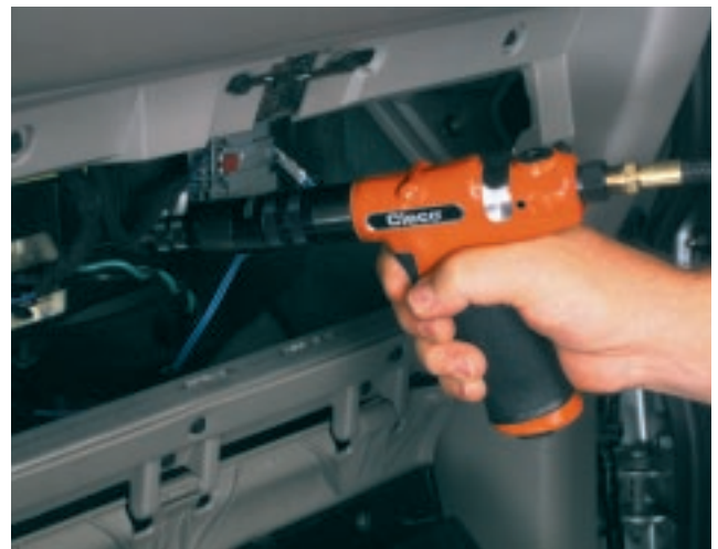
Verdeckte, aber leicht zugängliche Drehmomenteinstellung, verringert den unsachgemäßen Zugriff.
